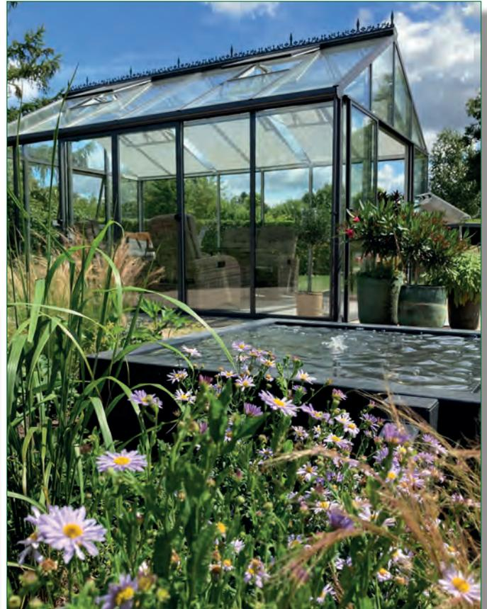
Dieser neue Gewächshaustyp lässt sich in Selbstmontage nach dem Baukastensystem einfach errichten: sämtliche Teile werden zusammengesteckt. Zum Einsatz kommen lediglich 20 bis 30 gleiche Schrauben, auch die Scheiben sind alle gleich groß, so dass beim Aufbau nichts verwechselt werden kann.
